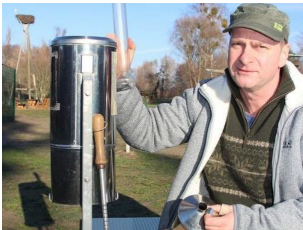
Michael Kaatz mit Schneemessstab und Schneeblech (im Hintergrund) neben dem Hellmann-Regenmesser aus Edelstahl. Jeden Morgen misst Kaatz hier die Niederschlagsmenge der vergangenen 24 Stunden. Foto: Stephen Zechendorf
